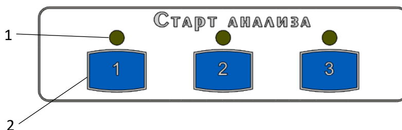
Рисунок 4 – Панель управления – верхний блок индикаторов и кнопок. 1 – Световой индикатор этапа «Анализ» каналов 1, 2, 3; 2 – Кнопки запуска/остановки анализа.
