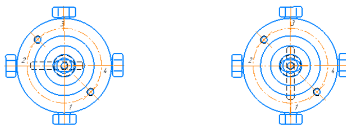
Штифт в крайнем правом положении: "Анализ" Штифт в крайнем левом положении: "Отбор"
