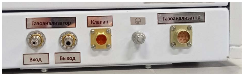
Рисунок 2. Расположение штуцеров и разъемов на задней нижней панели хроматографа.
