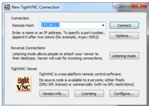
Скачайте и установите [TightVNC](#) на ПК (ноутбук) оператора. Для подключения запустите TightVNC клиент в поле «Remote Host:» укажите IP-адрес прибора ПГХ-1000 и нажмите кнопку «Connect».
