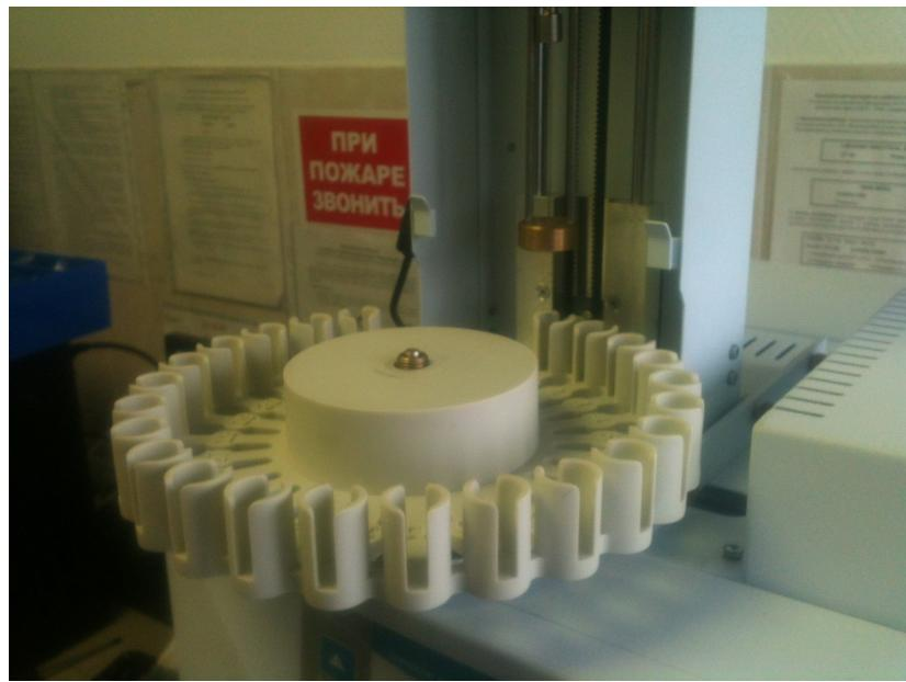
Рисунок 12 - Установка карусели на дозатор
