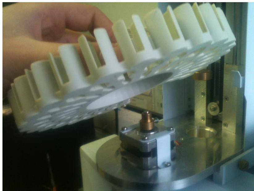
Рисунок 11 - Установка карусели на дозатор
