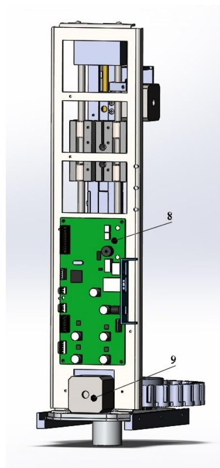
Рисунок 2 - Дозатор. Вид сзади
