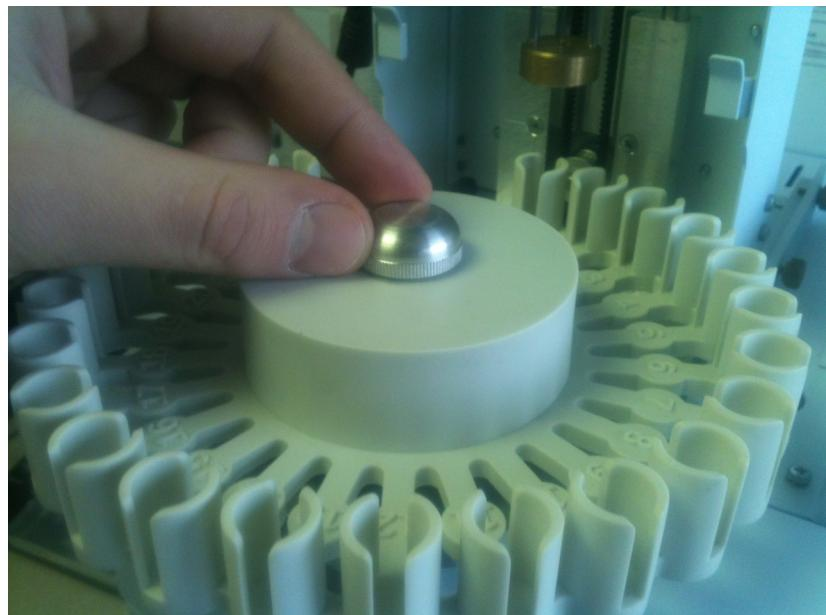
Рисунок 13 - Фиксатор карусели
