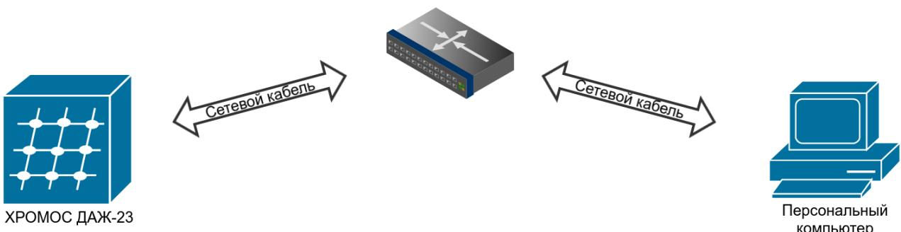
Рисунок 16 - Подключение через коммутатор или роутер
