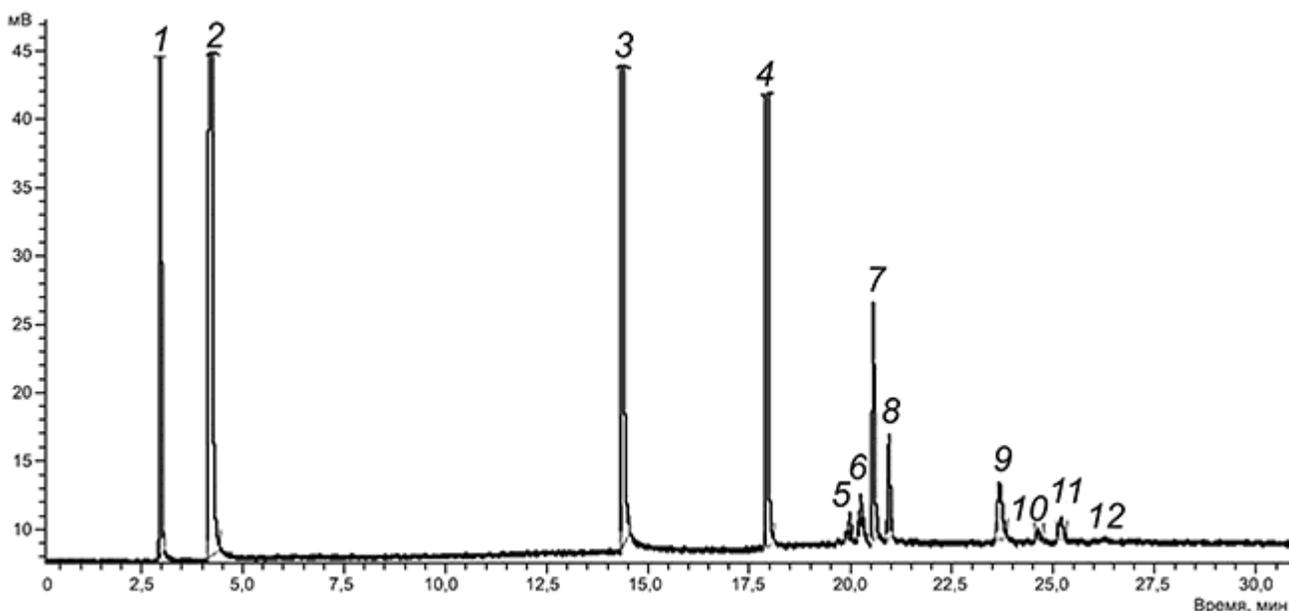
1 - карбонилсульфид; 2 - сероводород; 3 - метилмеркаптан; 4 - этилмеркаптан; 5 - диметилсульфид; 6 - тиофен; 7 - пропилмеркаптан-2; 8 - пропилмеркаптан-1; 9 - 2-метилпропилмеркаптан-2; 10 - 2-метилпропилмеркаптан-1; 11 - бутилмеркаптан-2; 12 - бутилмеркаптан-1
