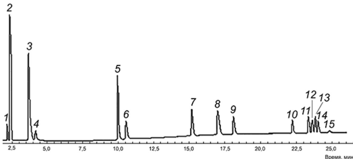
1 - воздух; 2 - метан; 3 - этан; 4 - диоксид углерода; 5 - пропан; 6 - сероводород; 7 - пропен; 8 - изобутан; 9 - *n*-Бутан; 10 - *транс*-Бутен-2; 11 - *бутен*-1; 12 - изобутен; 13 - изопентан; 14 - *цис*-Бутен-2; 15 - *n*-Пентан
