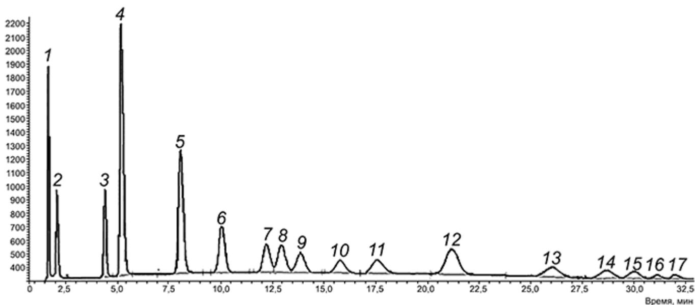
1 - метан; 2 - этен + этан; 3 - пропан; 4 - пропен; 5 - изобутан; 6 - *n*-Бутан; 7 - бутен-1; 8 - изобутен; 9 - *транс*-Бутен-2; 10 - *цис*-Бутен-2; 11 - бутадие-н-1,3; 12 - изопентан; 13 - 3-метилбутен-1; 14 - *n*-Пентан; 15 - пентен-1; 16 - 2-метилбутен-1 + *транс*-Пентен-2; 17 - *цис*-Пентен-2 + 2-метилбутен-2
