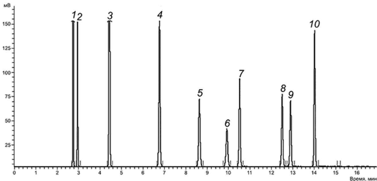
1 - сероводород; 2 - карбонилсульфид; 3 - метилмеркаптан; 4 - этилмеркаптан; 5 - пропилмеркаптан-2; 6 - 2-метилпропилмеркаптан-2; 7 - пропилмеркаптан-1; 8 - бутилмеркаптан-2; 9 - 2-метилпропилмеркаптан-1; 10 - бутилмеркаптан-1
